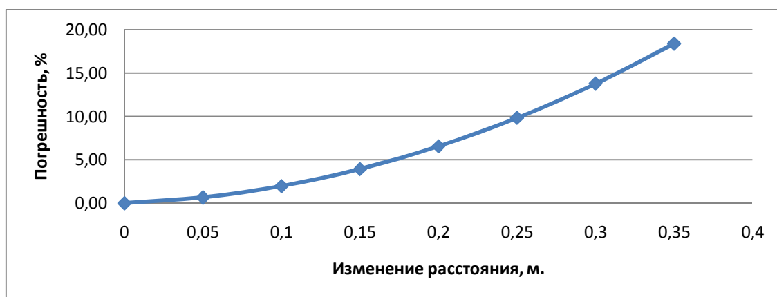
Рисунок 4 - Зависимость погрешности от расстояния до объекта
